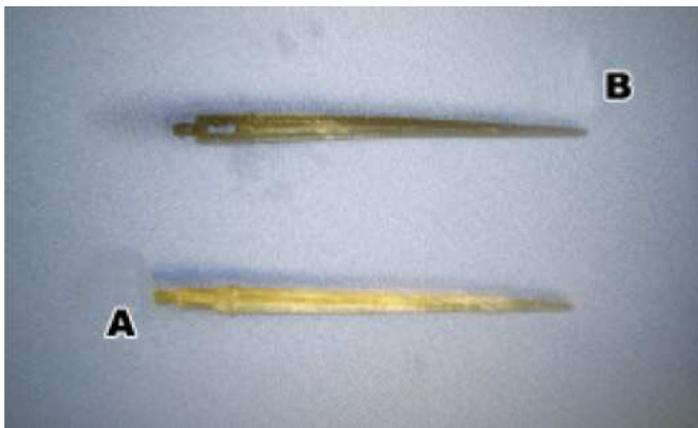
Aspecto de dos goteros autocompensantes y antidrenantes después de su uso durante una campaña agrícola con el tratamiento de un compuesto peroxiacético (B), y el testigo sin el tratamiento (A). Abajo vemos el aspecto de las piquetas de los goteros.
